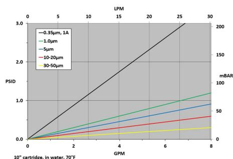
\*Pour les éléments ayant un diamètre extérieur de 11,43 cm, la pression différentielle correspond à 30 % des valeurs indiquées ci-dessus pour les cartouches au diamètre extérieur de 6,86 cm.
