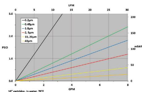
\*Toutes les données sont basées sur les éléments de filtration absolue. Les éléments de filtration nominale réduisent la chute de pression d'environ 10 %.
