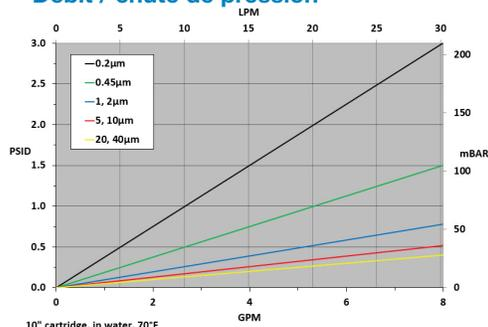
\*Toutes les données sont basées sur les éléments de filtration absolue. Les éléments de filtration nominale réduisent la chute de pression d'environ 10 %.
