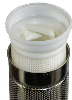
Un élément filtrant soudé entièrement homogène dans un seul matériau (polypropylène ou polyester) avec une fonction de joint intégrée et une compensation de la longueur pour un montage précis dans le panier.
