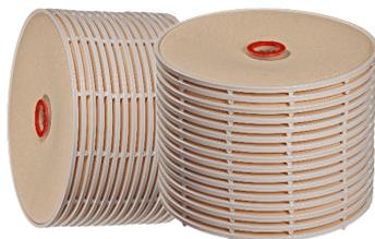
Les modules lenticulaires de la série GSD sont composés de cellules faites à partir d'un mélange de cellulose et de terre de diatomées (DE). Chaque lentille dispose de bordures et de séparateurs en polypropylène. Les joints sont disponibles dans différents matériaux pour permettre une large compatibilité chimique et une utilisation dans un grand nombre d'applications liquides. Disponibles en 12" et 16" .
