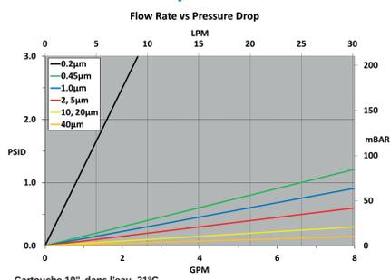
\* Toutes les données sont basées sur les éléments de filtration absolue. Les éléments de filtration nominale réduisent la chute de pression d'environ 10 %.
